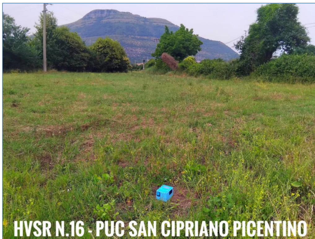
Figura 15 - esecuzione prove geofisiche HVSR
