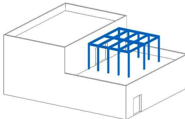
nella parte superiore. Il pergolato non prevede delle fondazioni, anche se è possibile ancorare la struttura al pavimento al fine di garantire la sicurezza. Il dimensionamento massimo realizzabile è pari a quanto stabilito per le tettoie. Si potranno effettuare delle chiusure laterali per un massimo del 50% di ogni lato con griglie e/o teli ombreggianti; Possono essere anche montate in aderenza alla struttura di cui è al servizio.
